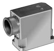
**MIL-C83733:** I serracavi per i connettori MIL-C-83733 sono disponibili in tre modelli che offrono o un morsetto da cavo standard, strain relief a sella, o una piattaforma di fascettatura schermata EMI. La giunzione a linguetta garantisce eccellente EMC. E' possibile scegliere fino a sei punti di ingresso cavo. Il corpo del serracavo è in lega d'alluminio con struttura in acciaio inossidabile passivizzato. E' disponibile un'ampia gamma di finiture, incluse quelle personalizzate.
